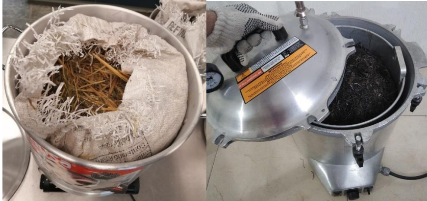
Figura 14. Pasteurización de la paja de trigo a la izquierda y esterilización del sargazo a la derecha.
