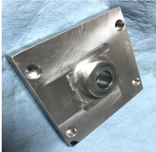
Figura 35. Pieza diseñada para disminuir variación de giro del chuck.
