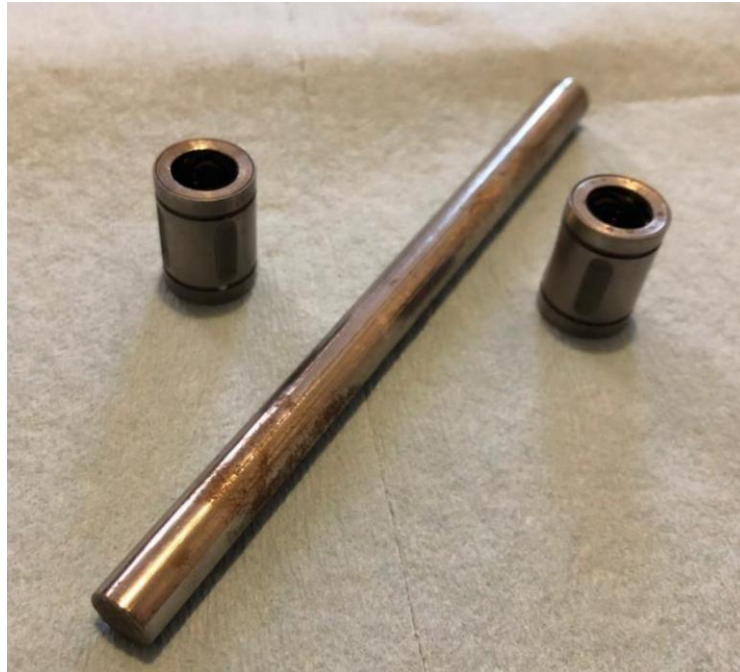
Figura 26. Barra estriada y oxidada con baleros rotos.
