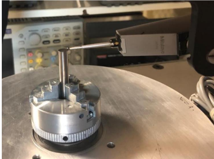
Figura 47. Centrado de pieza con palpador.
