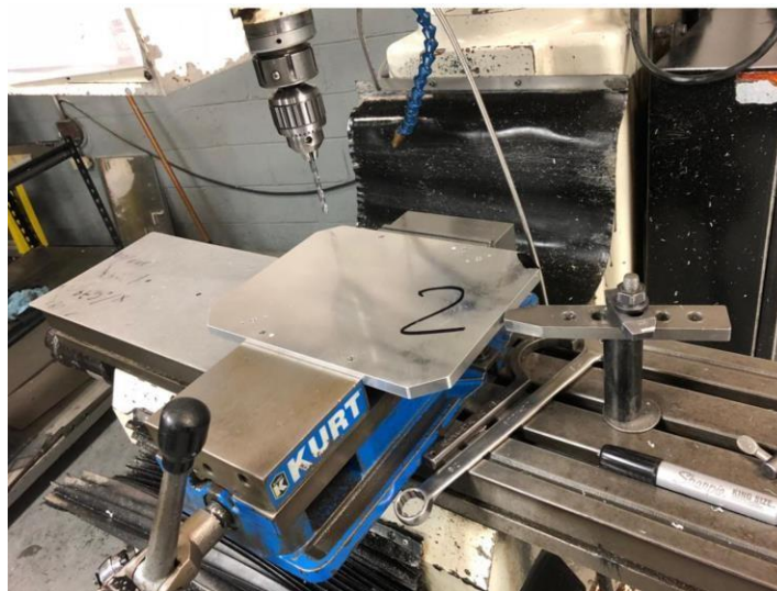
Figura 23. Maquinado de placa base.
