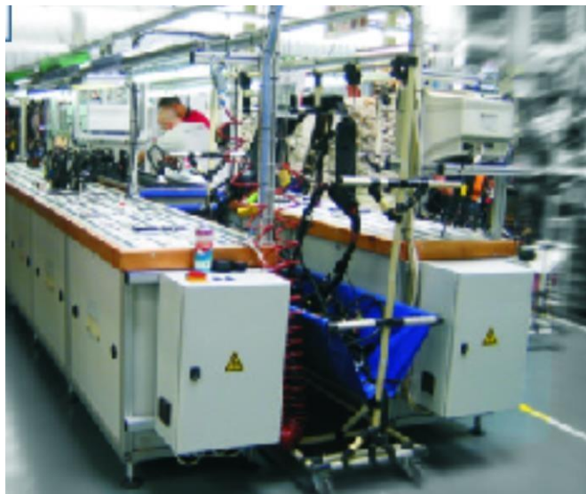
Figura 13. Línea de prueba eléctrica en Kufferath de México.
