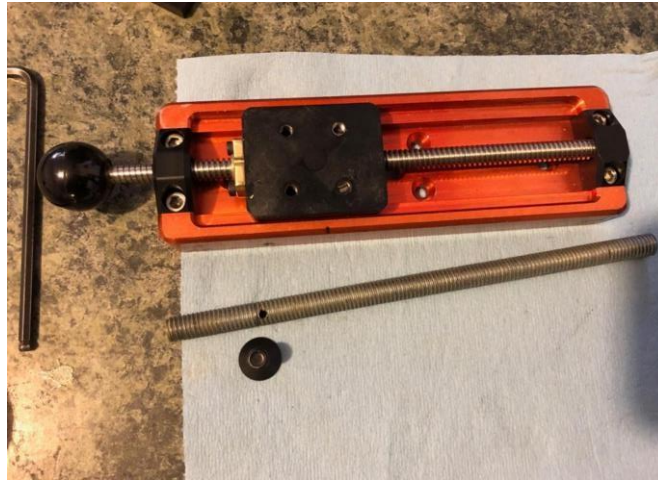
Figura 30. Sistema de desplazamiento en eje “Y”
