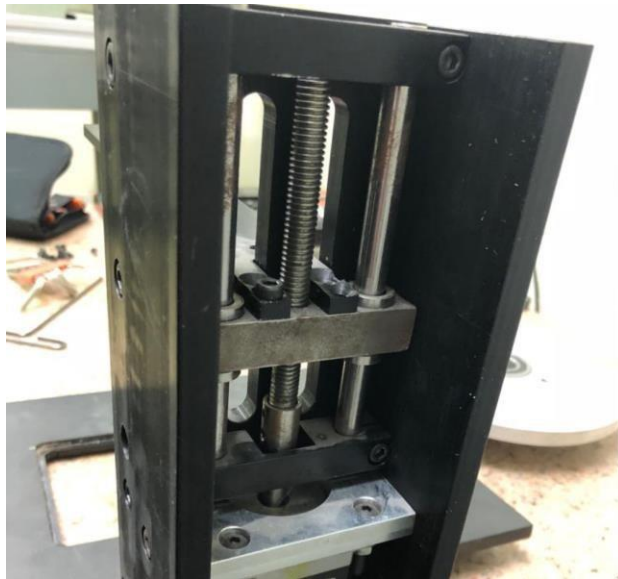
Figura 19. Sistema de desplazamiento en el eje “Z”.
