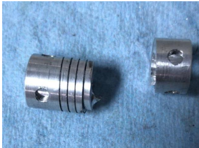
Figura 38. Cople de seguridad quebrado.
