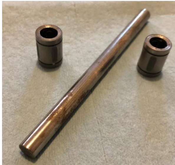
Figura 34. Barras Thompson dañadas y baleros rotos.
