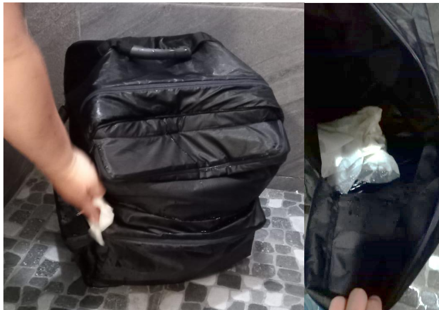
Figura 34 Prueba de humedad después. Nota: En la figura se muestran los resultados después de 5 minutos de prueba.
