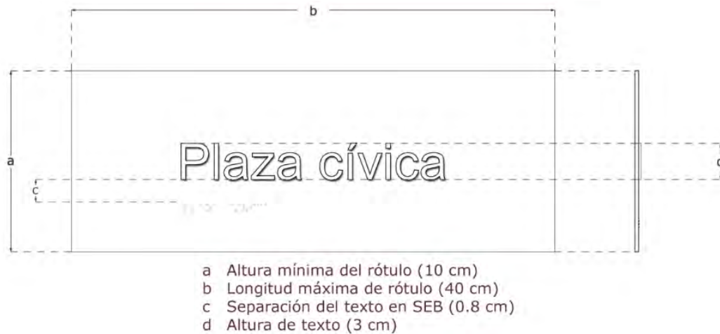
Figura 53 Dimensiones de señalética de acuerdo con las normas de accesibilidad federal.
