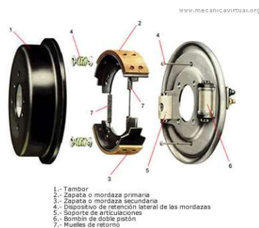
Figura 2.4. Elementos que forman un tambor de freno [6].
