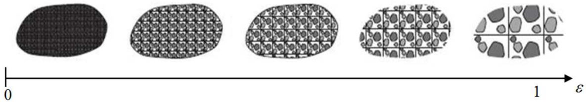
Figura 7. Microestructura del compuesto a diferentes escalas.
