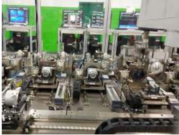
Figura 3.3 Probadora final de línea de producción, estación de medición de fuerza contra electromotriz.
