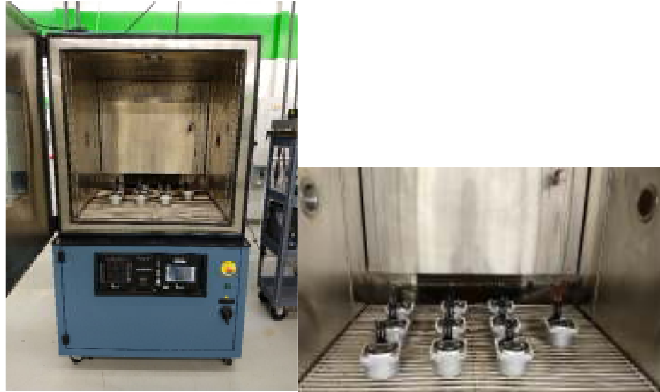
Figura 4.1 Preparación de la exposición de los motores a temperaturas altas en cámara ambiental.
