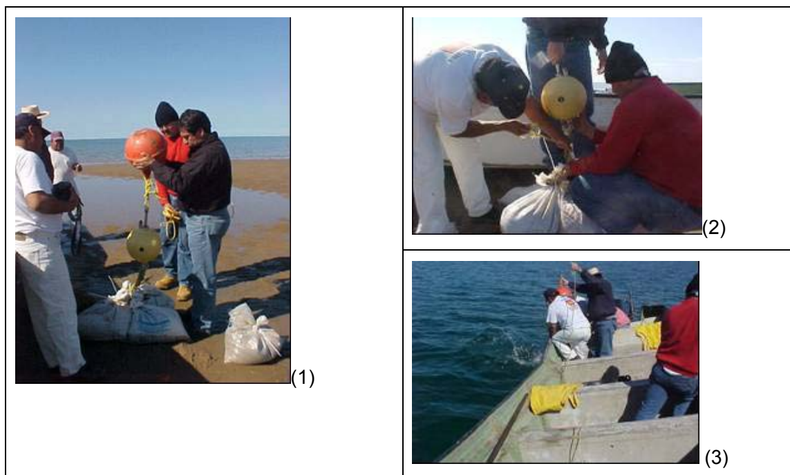
Fig 35. Aspectos de la boya oceanográfica de medición continua (1 y 2) y de colocación en el sitio de muestreo (3).
