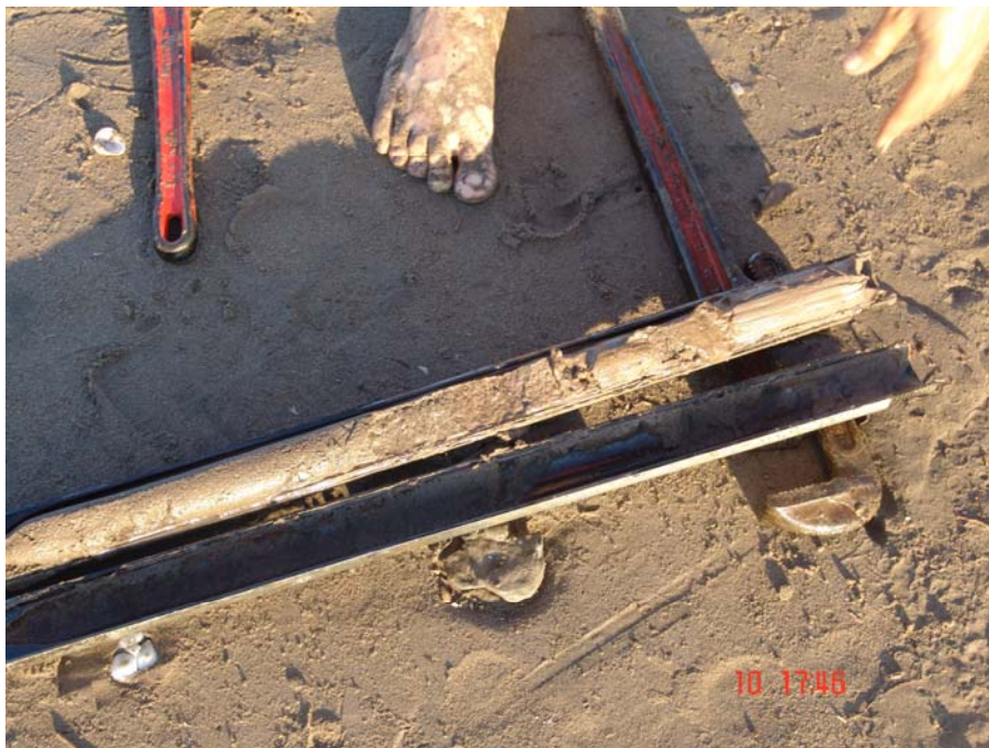
Fig. 51. Tubo partido con la muestra de material arcilloso y arcillo-arenoso colectado por la columna de penetración.
