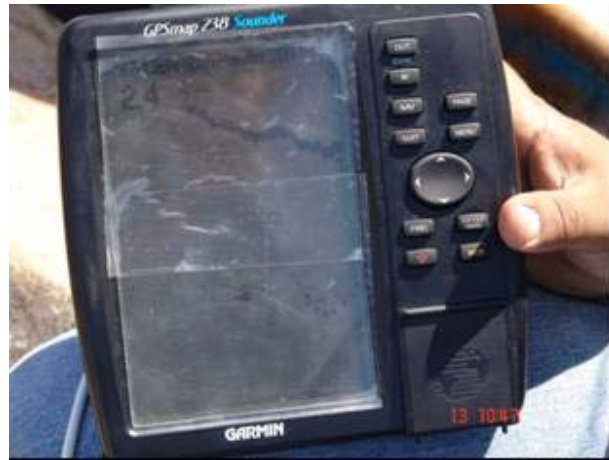
Fig. 42. Detalles de la ecosonda utilizada para el levantamiento batimétrico en campo.
