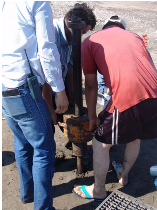
Fig 50. Maniobra de percusión para la penetración de la columna de muestreo.
