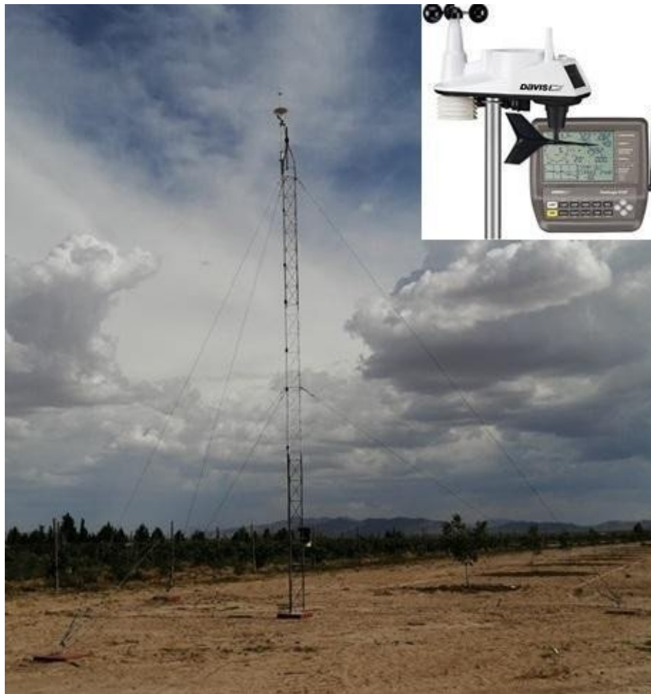
Figura 13. Estación climatológica Modelo Davis Vantage Vue 6250 (CeTraTecIA)
