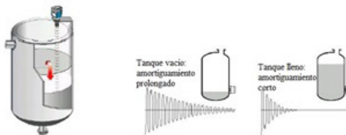
Figura 12. Ejemplo de sensor ultrasónico utilizado en un silo. Fuente: Manual de instrumentación aplicada
