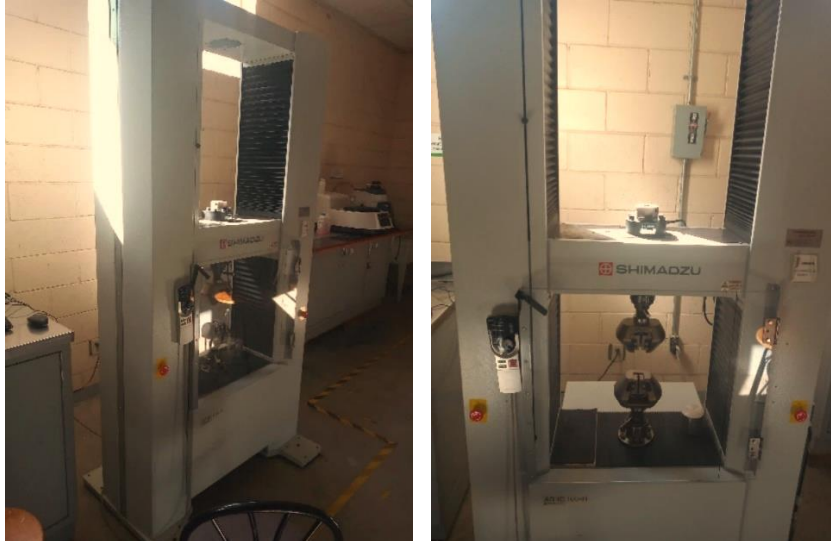
Figura 23. Máquina universal de ensayos Shimadzu AG-IC 100kN Fuente: Elaboración propia
