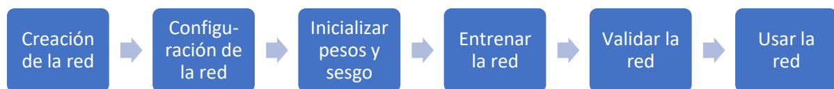
Figura 12. Flujo de trabajo con la GUI de la NNT en MATLAB
