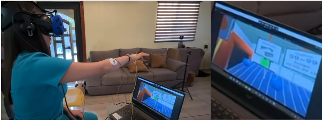
Figura 3.12: Participante interactuando con el sistema Handly utilizando el visor HTC Vive, el sensor Leap Motion y electrodos de electromiografía superficial (sEMG).
