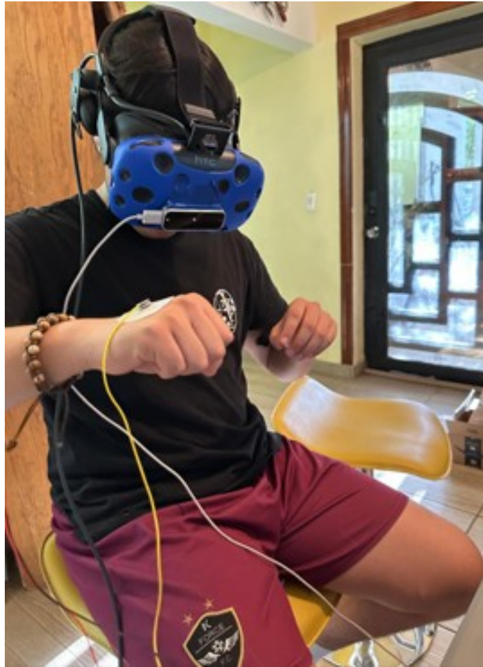
Figura 3.15: Colocación de los sensores de electromiografía superficial (sEMG) sobre el antebrazo del usuario para el registro de la actividad mioeléctrica durante las tareas motoras.
