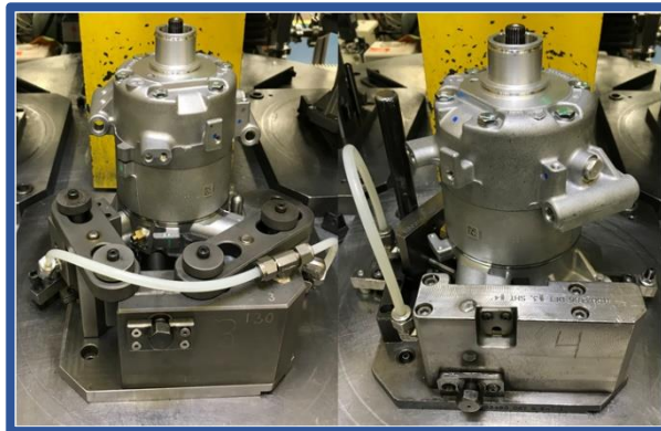
Figura 3.5. Nuevo y viejo diseño de fixturas módulo 3, modelo T30.
