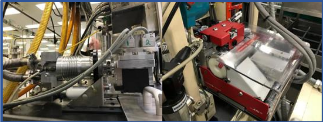
Figura 3.18. Espectrómetro ASI20 (antiguo) vs espectrómetro ASI35 (nuevo modelo)
