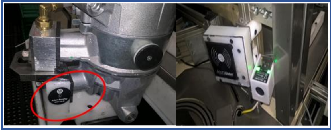
Figura 3.24. Sistema de rastreo de fixturas con RFID
