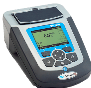
Figura 8. Equipo de laboratorio. Espectrofotómetro portátil DR1900 marca HACH.
