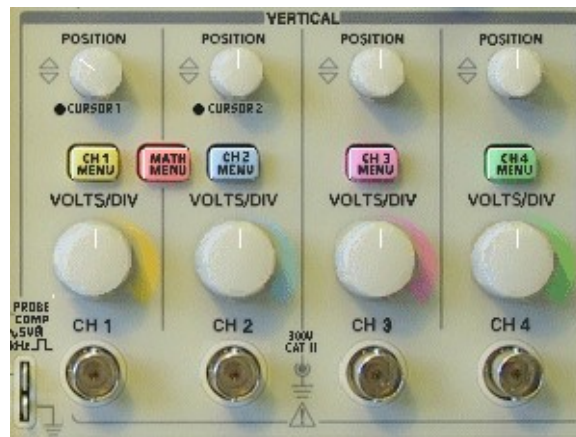
Figura 6.13 Grupo VERTICAL y sus respectivas perillas de los cuatro canales, además de los conectores de entrada en la parte inferior.
