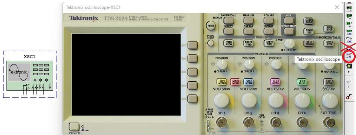
Figura 6.11 Osciloscopio Tektronix TDS 2024 insertado en el área de trabajo Multisim.
