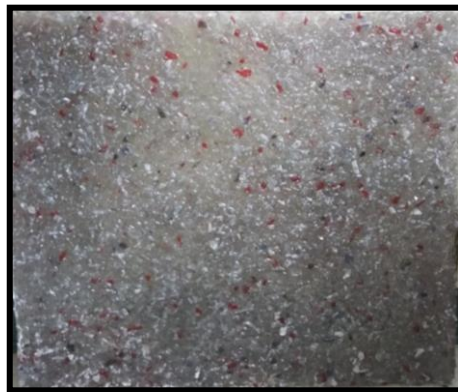
Imagen 27 Placa de Policarbonato con dimensiones de 40 x 50 cm.
