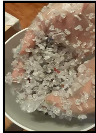
Imagen 16 Mezcla de Policarbonato y Silicón SIKAFLEX PRO11. Imagen propiedad del autor
