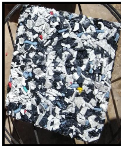
Imagen 21 Mezcla de plástico ABS triturado y silicón SIKAFLEX PRO11 después de casi 100 horas de secado. Imagen propiedad del autor.
