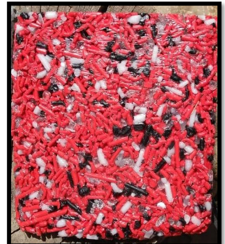
Imagen 22 Mezcla de plástico Poliacetal triturado y silicón SIKAFLEX PRO11 después de casi 100 horas de secado. Imagen propiedad del autor.
