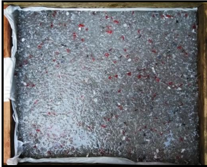
Imagen 26 Placa de 40 x 50 cm de Policarbonato con Resina epóxica Sayer Lack Sayer Art. Imagen propiedad del autor
