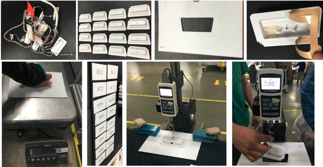
Figura 34. Pruebas con método actual adhesivo doble cara
