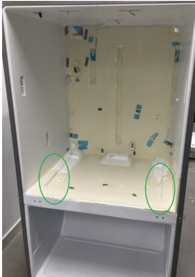
Figura 29. Ensamble de gabinete con liners superior e inferior ya espumado.
