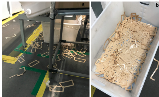
Figura 4. (a) (b) Desperdicio de plástico protector de base led
