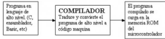
Figura 2.13. Esquema del microcontrolador (Electronica estudio, 2020)
