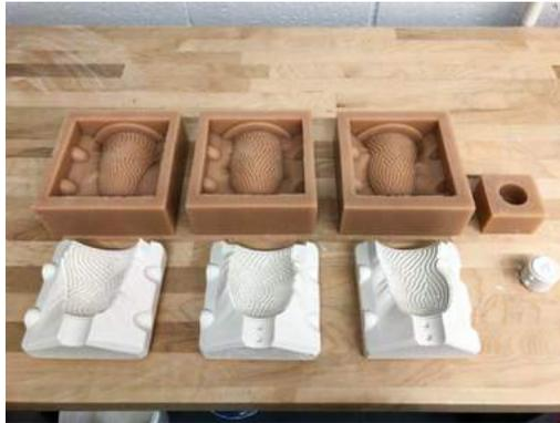
Figura 4.12 Moldes maestros y moldes de producción (Nervous System, INC, 2018)
