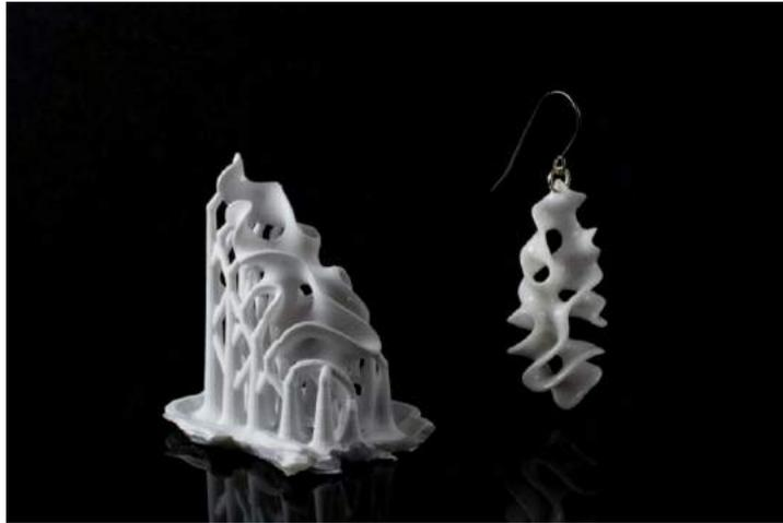
Figura 4.21 Pieza con soportes y pieza terminada (Nervous System, 2018)
