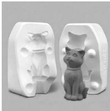
Figura 2.7 Ejemplo de molde de vaciado y pieza resultante (Krueger Pottery Supply, 2020)
