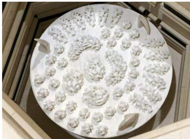
Figura 4.22 Piezas terminadas dentro del horno (Nervous System, 2018)
