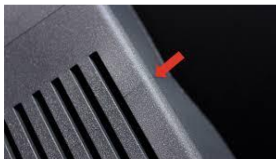
Figura 2.4 Líneas de soldadura
