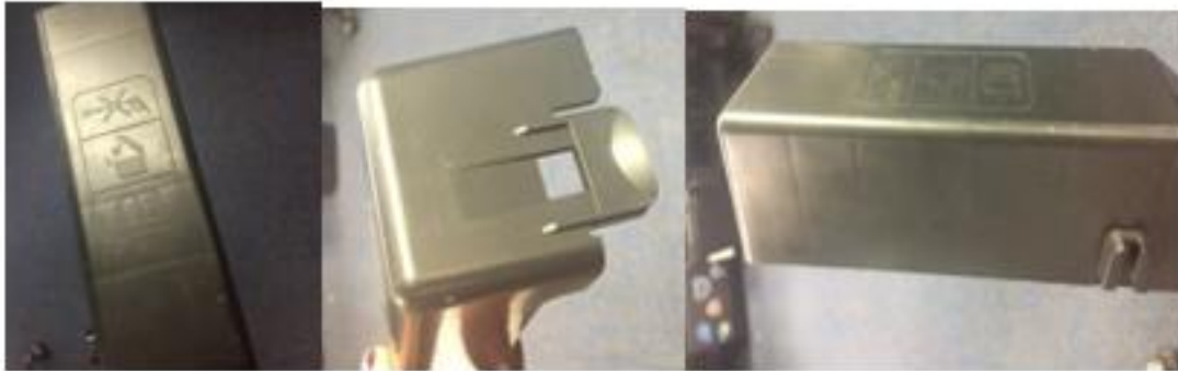
Figura 3.2 Fotos de cubierta de central eléctrica con sink marks
