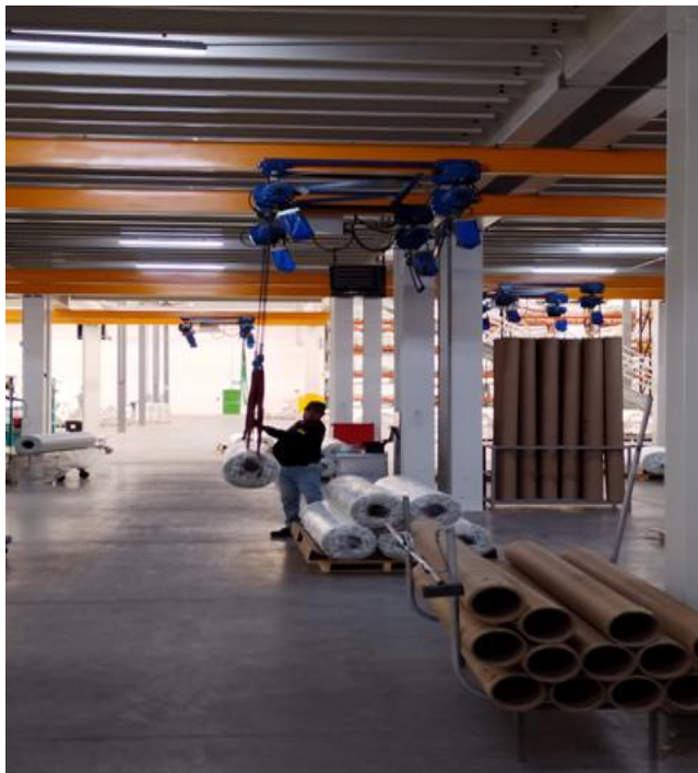
Figura 1.5 Transporte de rollos de fibra de vidrio con grúas aéreas.
