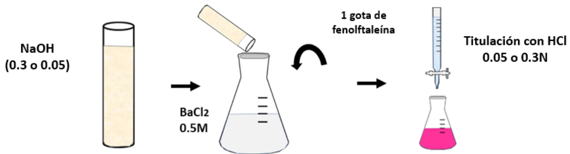
Figura 9. Titulación de trampas alcalinas con hidróxido de sodio (NaOH) a la solución de cloruro de bario ( \text{BaCl}_2 ) más la adición de un indicador (fenolftaleína) y la posterior titulación con ácido clorhídrico (HCl) para la evaluación de \text{CO}_2 y respiración basal.
