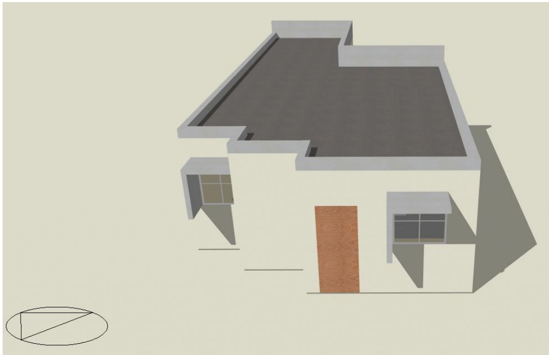
Figura 29 Visualización de Simulación de estrategia Aleros y partesoles (AP) fachada Sur-Poniente y Poniente 6:00 p.m. Elaboración propia mediante Desing Builder
