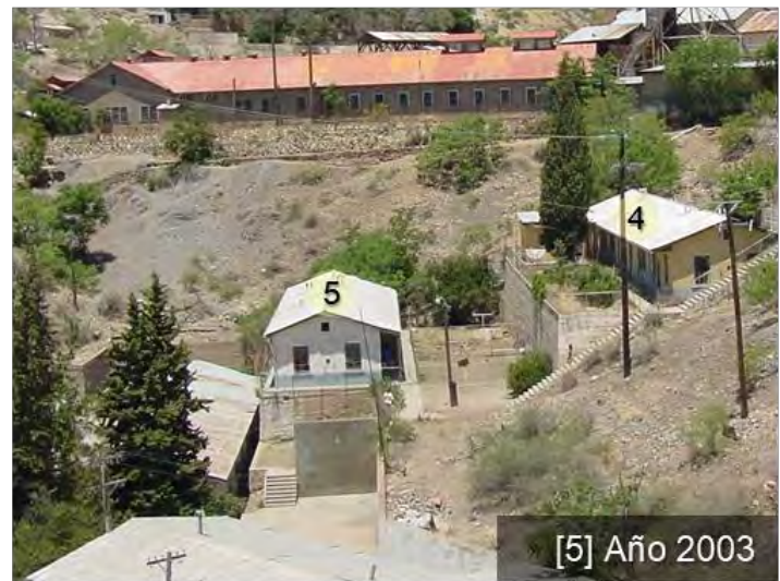
Figura 50. Zona residencial para empleados casados. Los conjuntos 1, 2 fueron ampliados en 1930, los conjuntos 4 y 5 fueron construidos entre 1930 y 1935 a base de muros de adobe, pisos de cemento y cubierta de lámina a dos aguas contaron con servicios de agua drenaje y electricidad. Por la topografía se realizaron plataformas contenidas entre muros de mampostería y cemento, toda el área se comunica a través de escalinatas de concreto, se destacan espacios de ante jardín. Fuente: [1 y 3] Fotografías tomadas el 9 de marzo de 2018. Autor Nayde Tepox; [2] Elaboración propia; [4 y 5] Fotografías tomadas el 7 de junio de 2003. Autor Rogelio Oaxaca.
