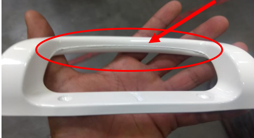
Figura 3. Pieza pintada, con defecto en líneas de unión. Elaboración Propia.
