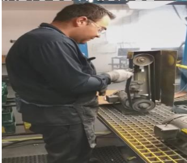
Figura 9. Lijadora para eliminar rebaba. Elaboración Propia
