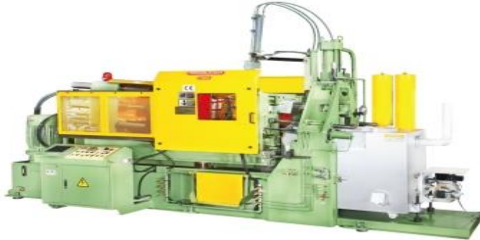
Figura 15. Máquina Marca Producer modelo DH-P 300 toneladas.
