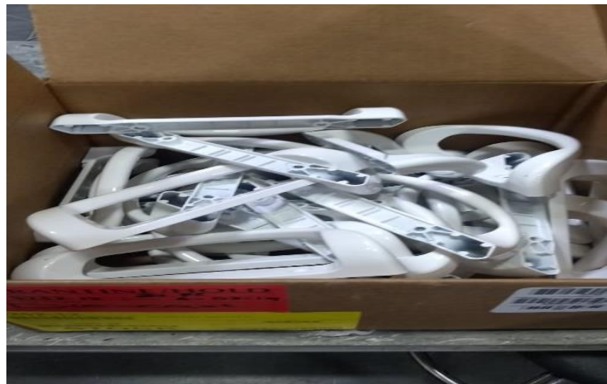
Figura 4. Cajas con piezas pintadas con el defecto de la línea de partición. Elaboración Propia.
