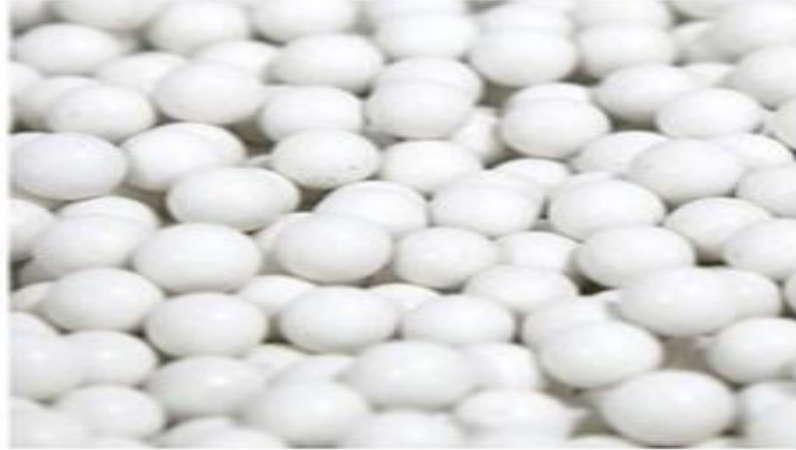
Figura 14. Tipos de Media de porcelana tipo esfera. Fuente: (Incorporated, 2018)
