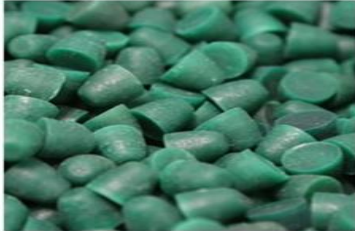
Figura 13. Media de plástico para corte y pulido. Fuente: (Incorporated, 2018)
