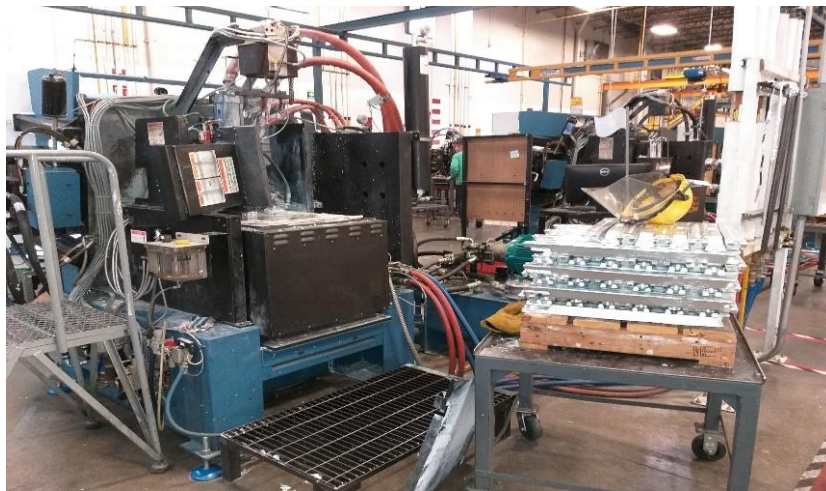
Figura 7. Zinc en barras para colocarse dentro del crisol para fundirlo. Fuente: (Alamy, 2020).
