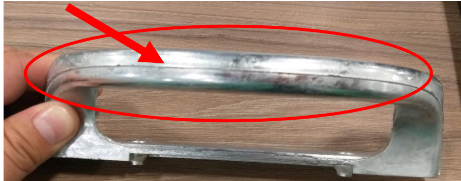
Figura 1. Línea de Union muy marcada. Elaboración propia.
