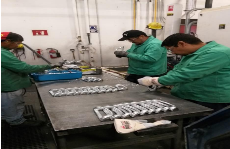
Figura 5. Proceso de rebabado (Flash). Elaboración Propia.
