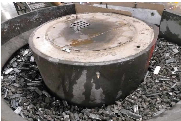
Figura 10. Vibrador circular tipo Bowl. Elaboración Propia.
