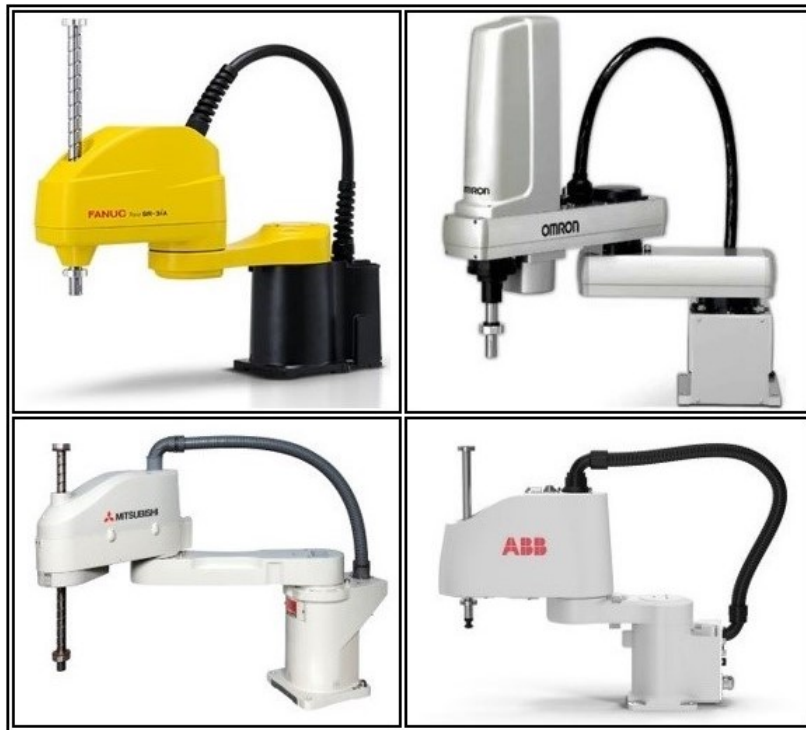
Figura 3.1: Manipuladores SCARA de 3 gdl comerciales.
