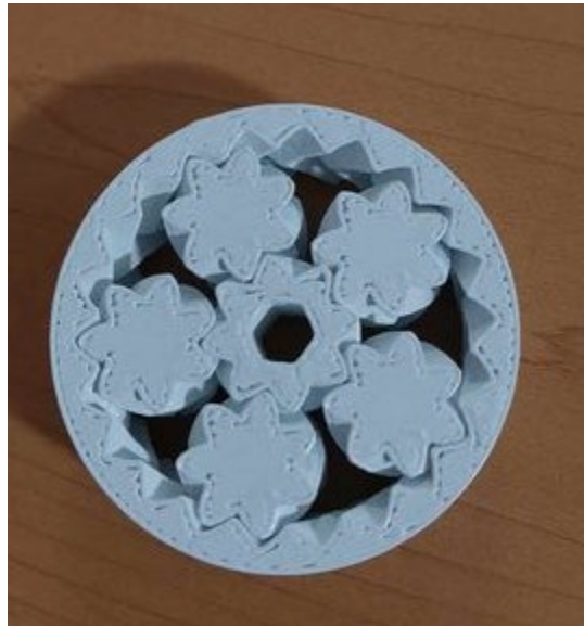
Figura 25 Prueba de impresión 3d de rodamiento Hemmett
