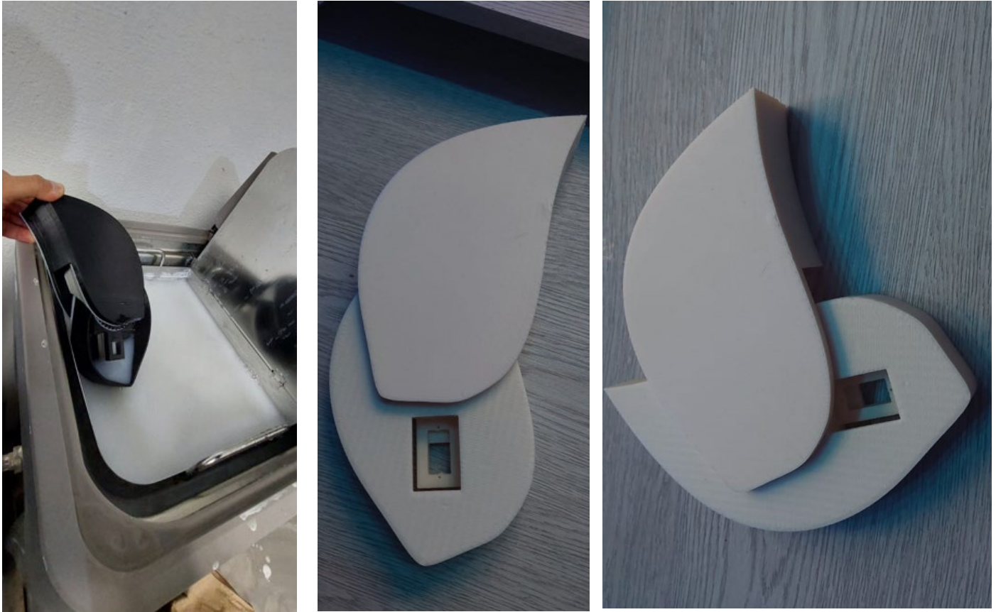
Figura 30. sección de brazo robótico con articulación integrada impreso
