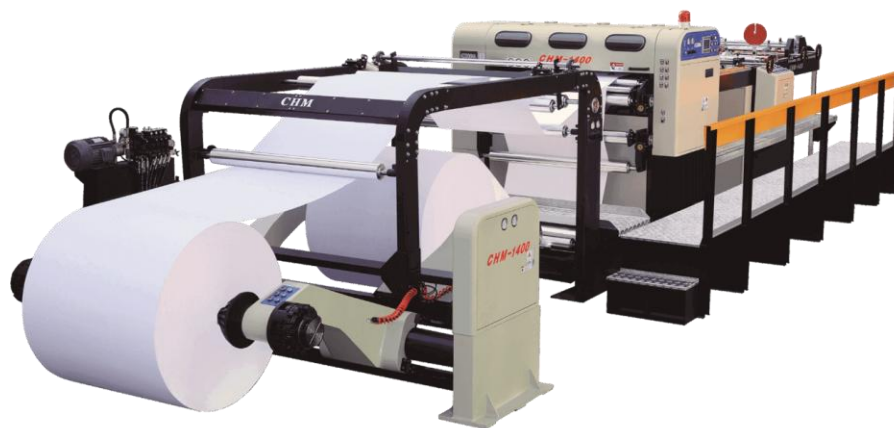
Figura 4.2 Sistema de corte de papel tipo sheeter CHM 1400.
