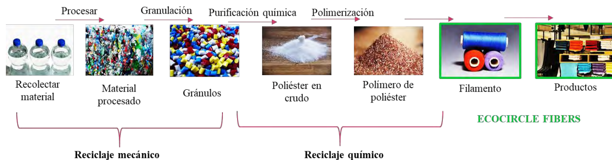
Figura 23. Método de manufactura para del poliéster reciclado (Grain, 2016)
