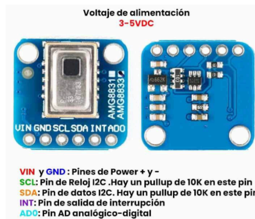
Figura 11 Sensor de temperatura infrarrojo AMG8833 https://uelectronics.com/producto/camara-termica-amg8833-ir-8x8-raspberry/
