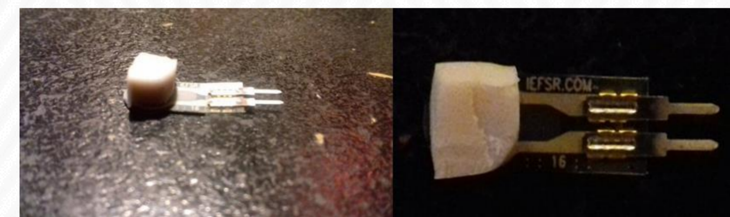
Figura 6. Aumento que se adecuó a los sensores para lograr sentir el objeto.
