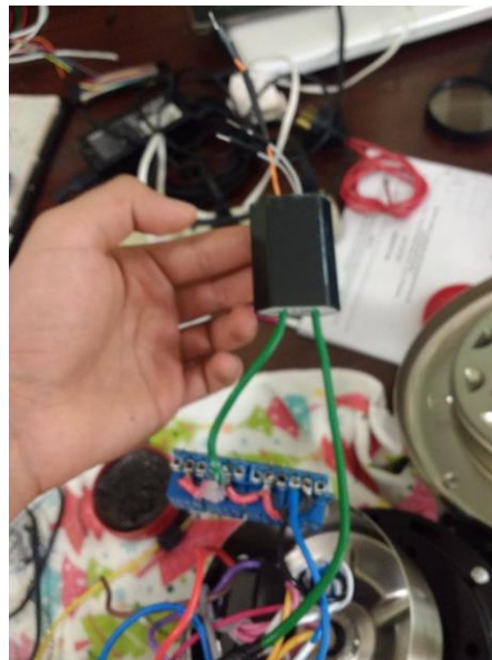
Figura 3.48: Pegado de cables a terminales del relevador Fuente:Elaboración propia.
