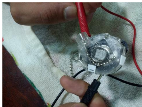
Figura 3.9: Revisión de continuidad en interruptor 2. Fuente: Elaboración propia.
