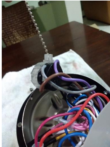
Figura 3.4: Extracción del interruptor de velocidades Fuente: Elaboración propia.
