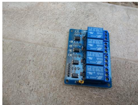
Figura 3.13: Relevador Fuente: Elaboración propia.
