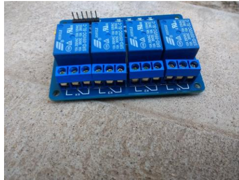
Figura 3.14: Relevador Fuente: Elaboración propia.
