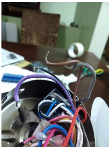
Figura 3.7: Cables que conducen la energía para darle distintas velocidades al motor
