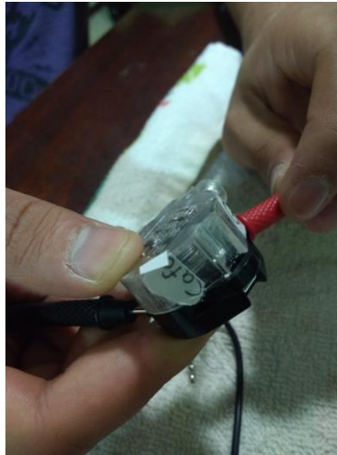
Figura 3.8: Revisión de continuidad en interruptor 1. Fuente: Elaboración propia.
