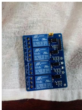
Figura 3.18: Relevador Fuente: Elaboración propia.
