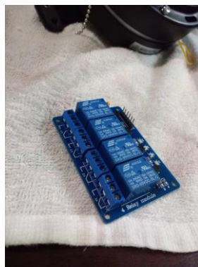
Figura 3.17: Relevador Fuente: Elaboración propia.
