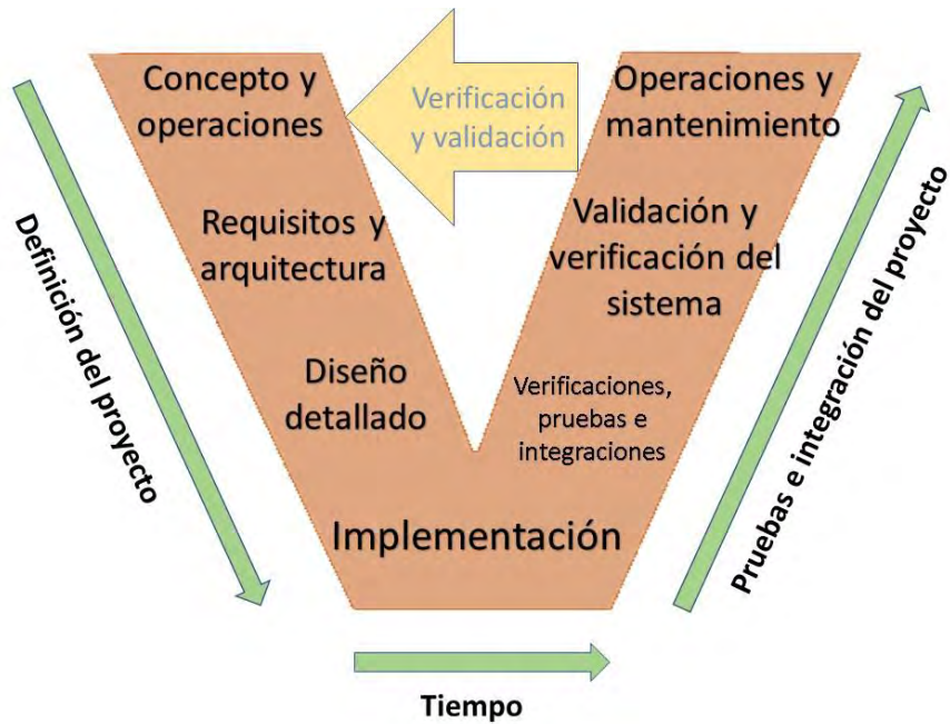
Figura 7. Esquema de metodología en V. Fuente: Claus: Concept of operations
