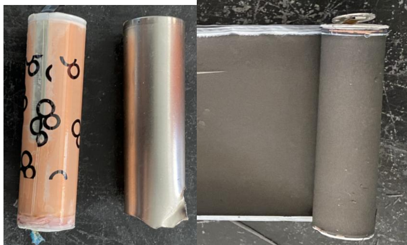
Figura 5.-Desarmado de batería sin necesidad de una atmosfera controlada después de ser sumergida en una solución NaCl durante 24 h.
