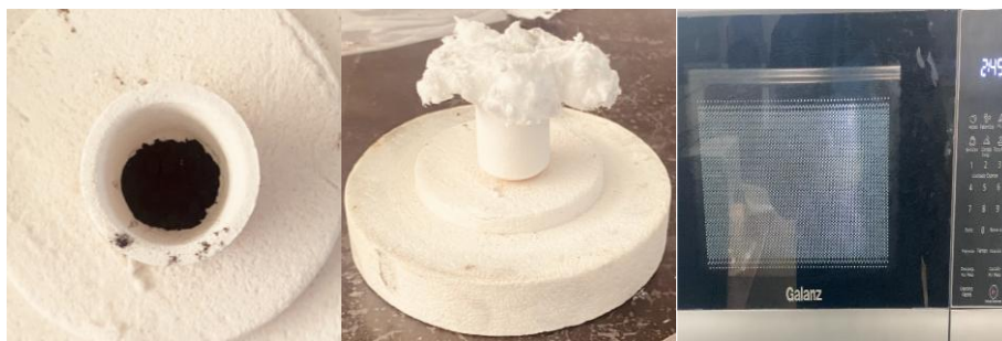
Figura 7.-Preparación de la muestra en un crisol cerámico previamente a ser expuesto a 8 minutos al microondas
