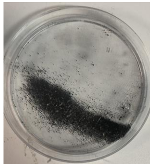
Figura 6.-Material recuperado del cátodo de la batería después del lavado y proceso de pulverización.
