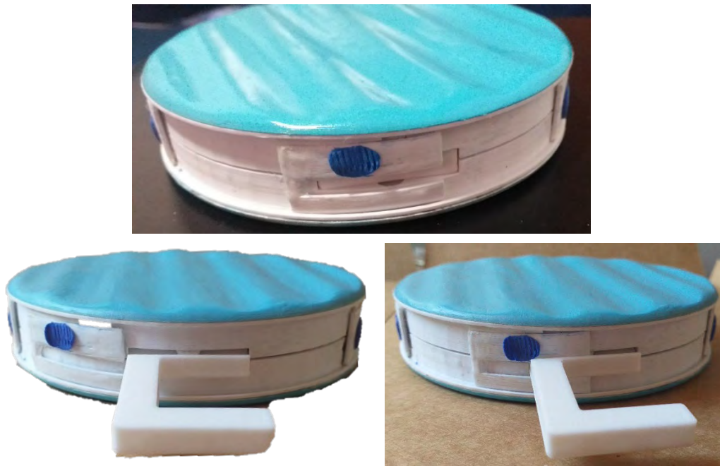
Figura 5.22. Demostración de como la puerta de esta herramienta se usa como soporte para el momento de presion
