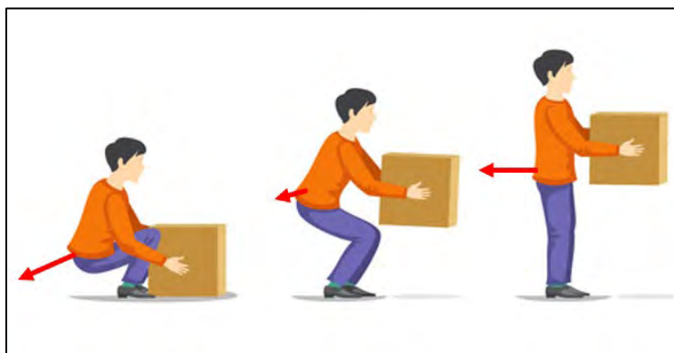
Figura 34. Fuerza lumbar en el eje Z durante el levantamiento.
