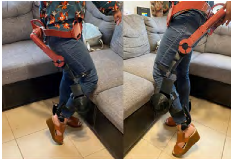
Figura 46. Pruebas de ajuste de ortesis de soporte lumbar.
