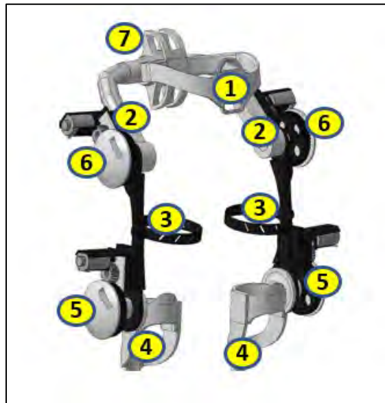
Figura 30. Detalle de partes de la ortesis lumbar.
