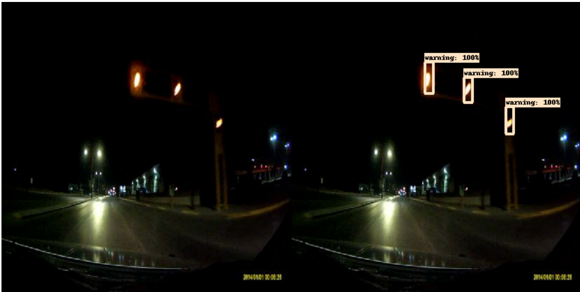
Figura 4.23: Comparación de imagen antes y después de ser evaluada, semáforo ubicado en avenida Ejercito Nacional.
