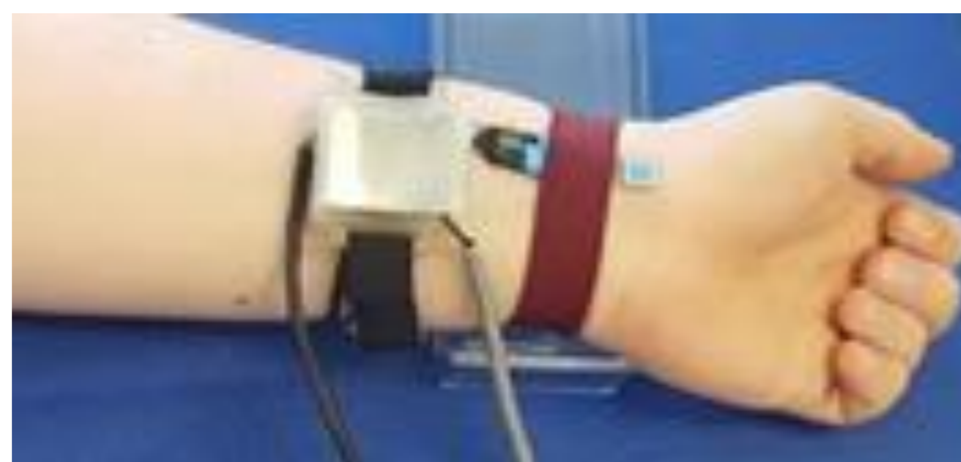
Figura 1. Sistema tipo brazalete que incorpora a dos electrodos secos, un sensor magnetorresistivo y un imán permanente.
