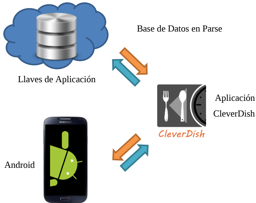
Figura 3.5 Esquema de la comunicación de las interfaces de la aplicación con la base de datos
