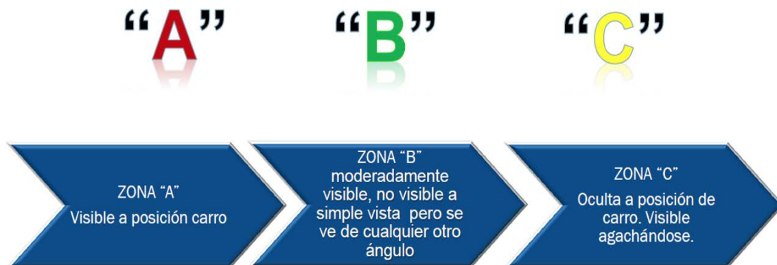
Imagen 4. Inspección por zonas. Propiedad de la industria maquiladora.
