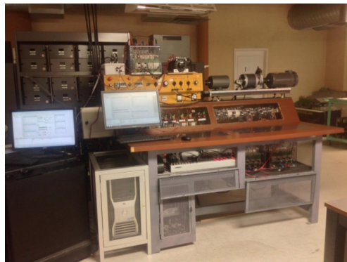
Fig. 2. Control de un sistema eólico a escala emulado en laboratorio
