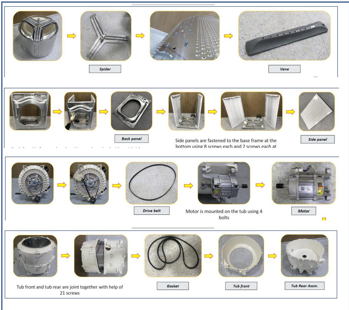
Figura 39 Principales componentes de la Lavadora
