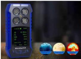
Para la determinación de la concentración de monóxido de carbono (CO), gas (EX) y oxígeno (O<sub>2</sub>) se hizo en tiempo real con detectores electroquímicos de calidad del aire, marca WYZXR, modelo BH-4S y los datos generados fueron guardados en el datalogger interno del equipo, mismos que se procesaron posteriormente para la generación de bases de datos. Rango de operación de 0-1000 PPM.
