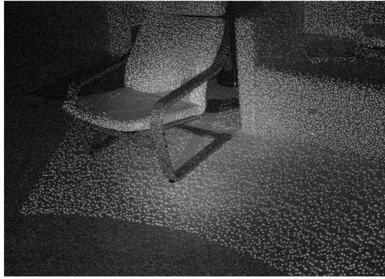
Figura 2: Nube de puntos de luz estructurada [14]
