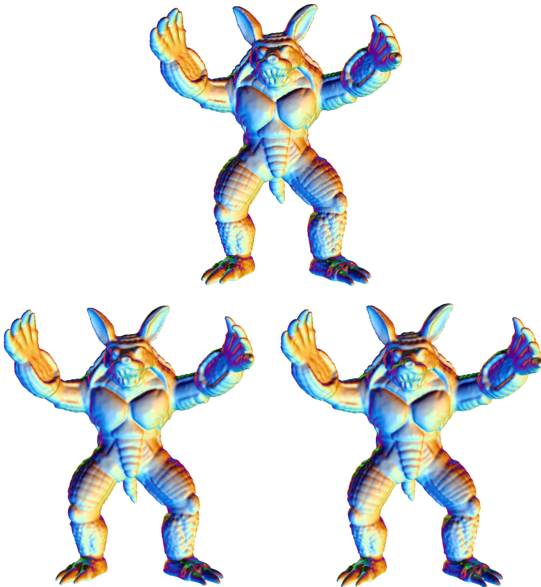
Figura 4.2: Modelo Armadillo (172974 puntos). Arriba: conjunto original de puntos. Izquierda: reconstrucción usando método original. Derecha: reconstrucción usando método propuesto.
