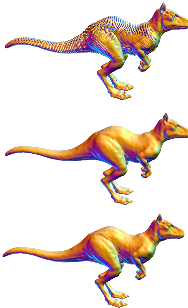
Figura 4.7: Modelo Dino (11642 puntos). Arriba: conjunto original de puntos. Medio: reconstrucción usando método original. Abajo: reconstrucción usando método propuesto.
